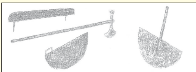
Arbeitsgeräte: Wasserbrett, Waalhaue; Wassereisen zum Aufstauen des Wassers für die Berieselung der Felder
